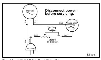
Fig. 15 #2767 / FK26 Fan Wiring Diagram
